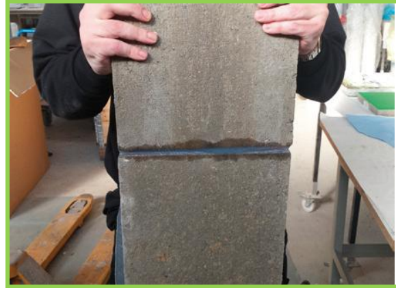
Тестване на адхезионна якост на Инжекционния Гел J4 КЪОСТЕР при фланговете
