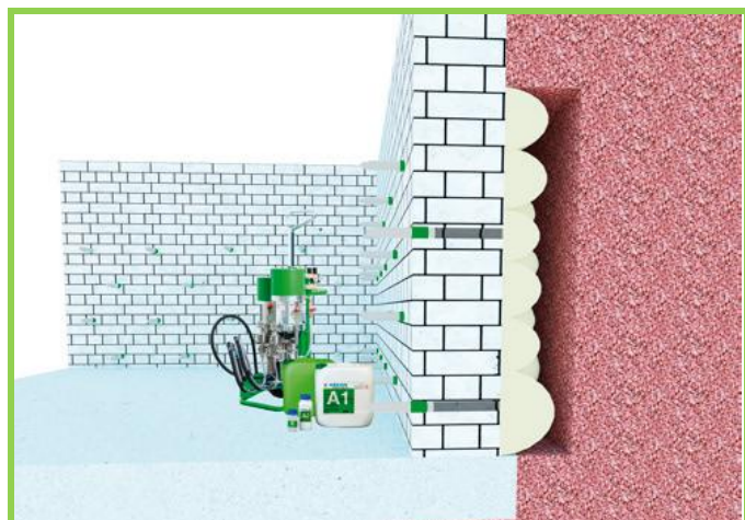
Завесно инжектиране през зидария с КЪОСТЕР Инжекционен Гел S4
