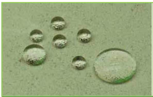
Хидрофобизиране: Строителният материал става водоотблъскващ.
