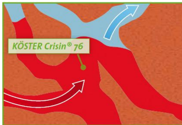
KÖSTER Crisin®76 прониква в капиллярите и избутва течностите извън тях.
